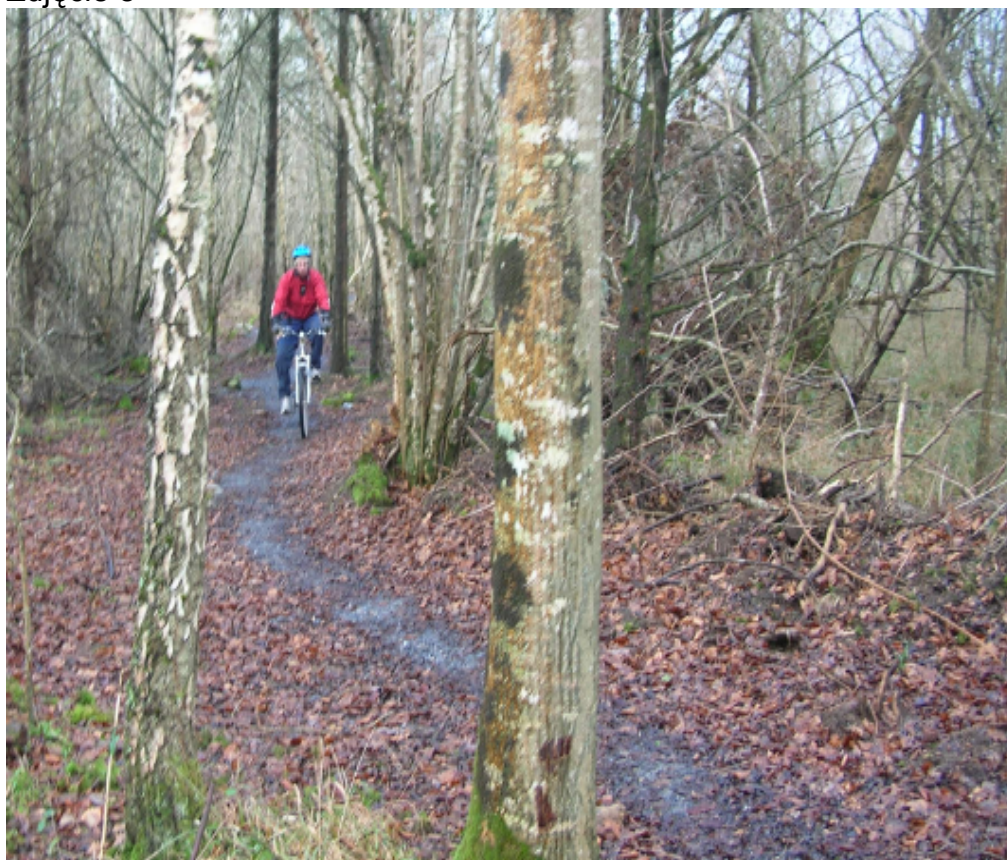
Zdjęcie 8 pokazuje typowy Szlak Kategorii 3 – zwróć uwagę na niewielką szerokość ścieżki, małe nachylenie oraz ubitą powierzchnię jezdnią szlaku.
