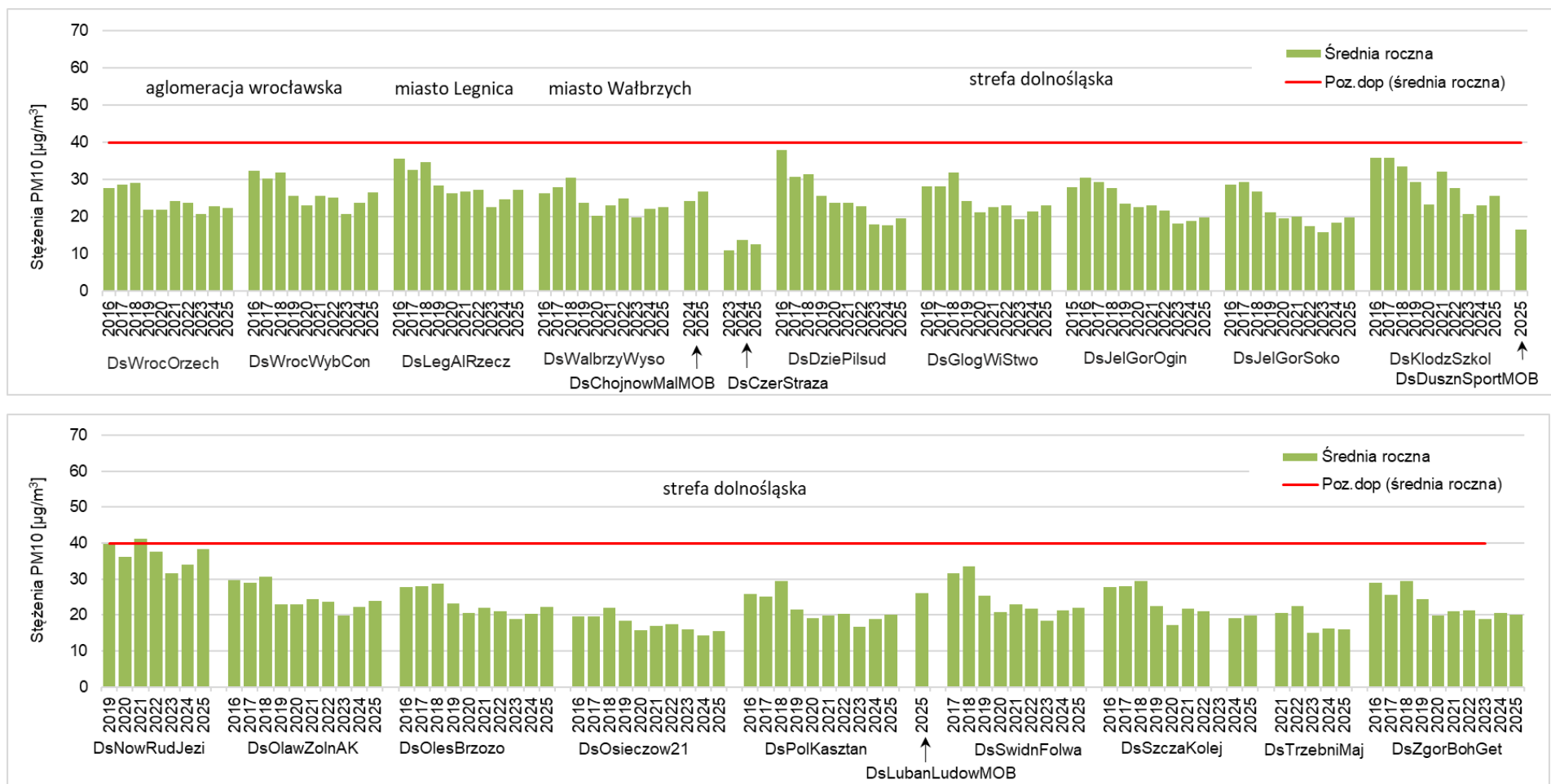
Rysunek 7.29. Przebieg wartości średniej rocznej stężenia pyłu zawieszonego PM10 na poszczególnych stanowiskach pomiarowych w województwie dolnośląskim, na tle poziomu dopuszczalnego w latach 2016–2025 [źródło: GIOŚ]
